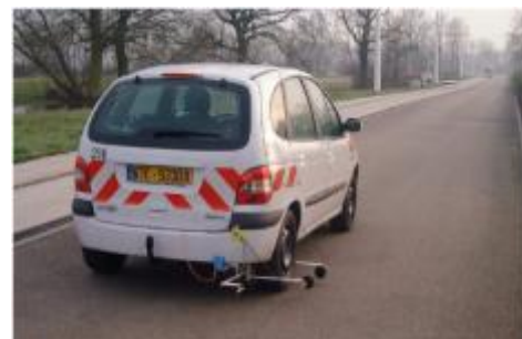
Figure 2.41 : Mesure du bruit de roulement en continu, [4].
