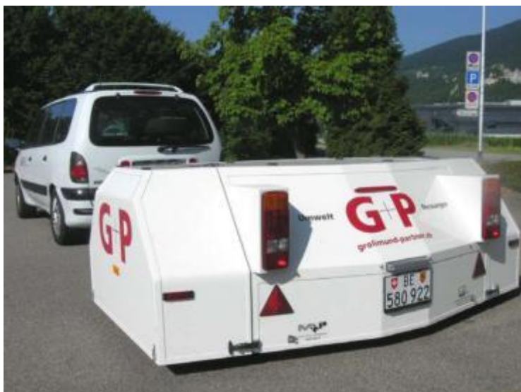
Figure 2.37 : Remorque de mesure CPX, [2].
