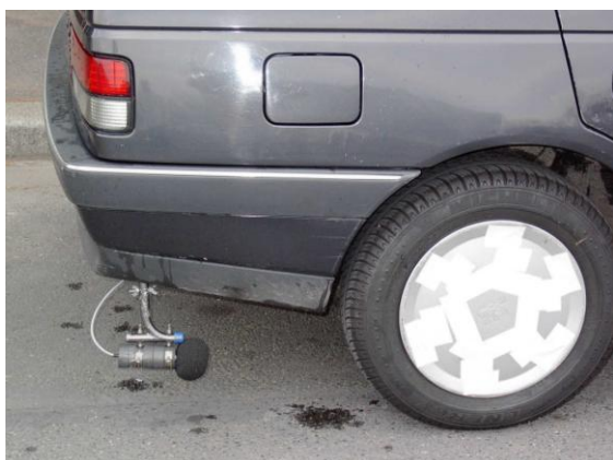
Figure 3.14 : Mesure du bruit de roulement en continu, [47].
