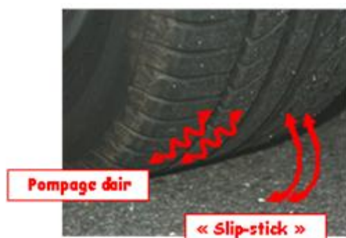
Figure 1.9 : Bruit dû au phénomène d'air pumping (source : COLAS).
