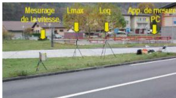
Figure 2.35 : Méthode statistique au passage (ISO 11819 - 1), [2].
