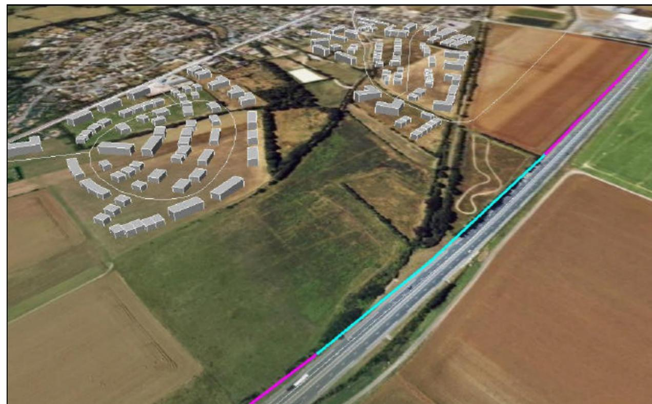
— : merlon H=4 mètres      — : Mur-anti-bruit H=4 mètres
